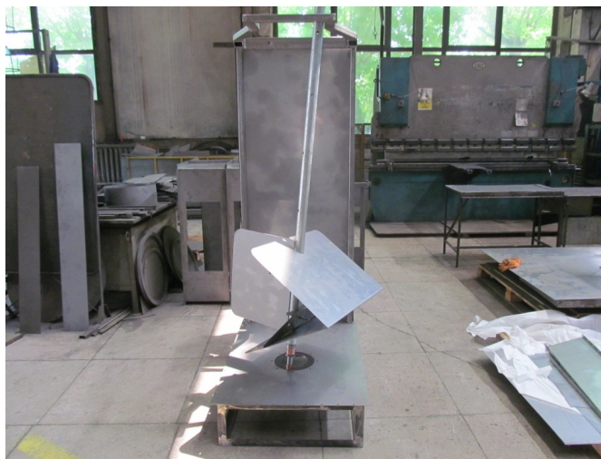
Fig. 1 Amestecătorul în faza de construcție.
