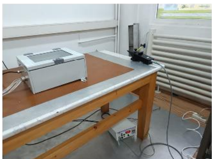
Amplasamentul pentru încercarea de imunitate la descărcări electrostatice
