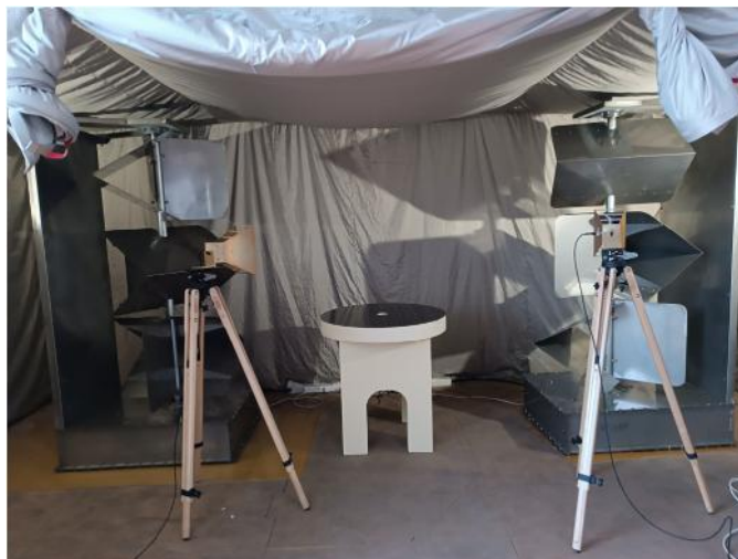
Fig. 2 Amplasamentul de încercare din incinta reverberantă.
